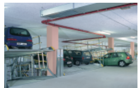
Der Parklift 340 eignet sich für Wohn- und Geschäftshäuser mit gleichbleibendem Nutzerkreis und wo geringe Grubentiefen und Einbauhöhen vorgesehen sind.
