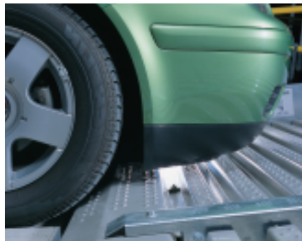
Auffahrt auf Parklift 340, oberer Stellplatz mit sportlich ausgelegtem Fahrwerk: der Frontspoiler sitzt nicht auf und hat genügend Distanz zur Plattform.
