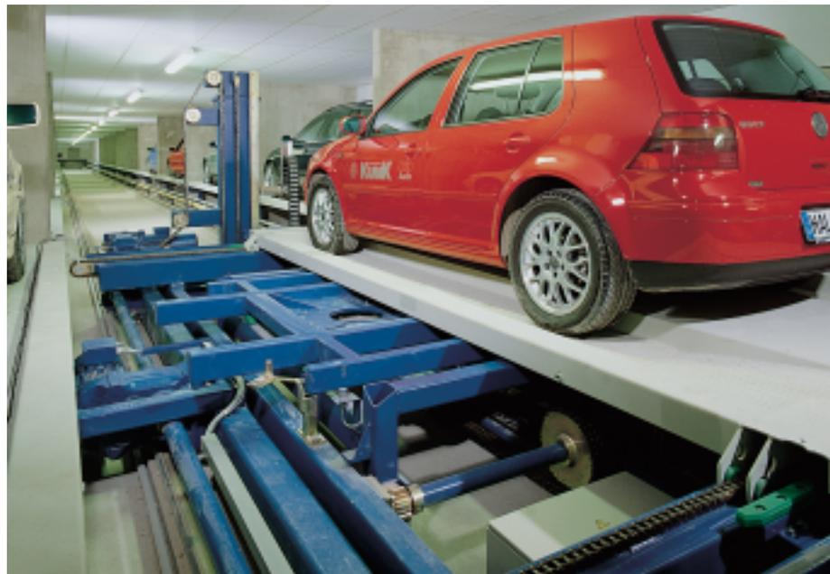
Die Regelung aller Antriebe erfolgt mit stufenlosem Beschleunigen und Abbremsen. Die Steuerungssysteme sind dezentral und unter Berücksichtigung der EMV-Vorschriften im Wohnbau über Interbus-S Anschaltungen vernetzt.
