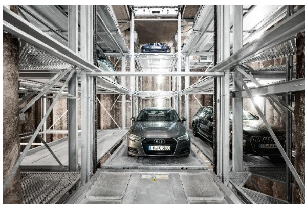
Bild 3 und 4: Automatisch wird die Plattform mit dem Fahrzeug von der Übergabekabine abgesenkt und in das freie Regalfach eingelagert.
