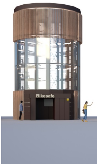
Fassadenbeispiel 3: bauseitige Gestaltungsmöglichkeit Glas und Holzlamellen
