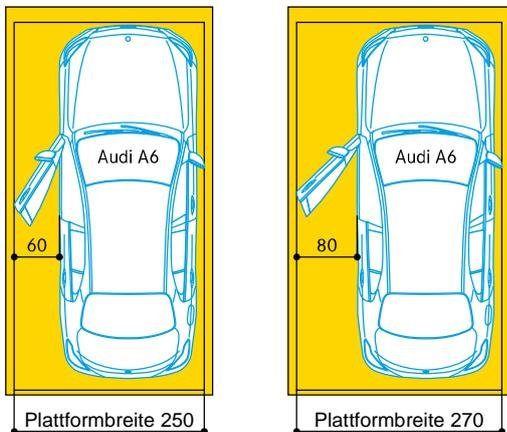
Je nach Fahrzeugmodell und Parkposition des Fahrzeugs auf der Plattform fällt der Platz zur Türöffnung unterschiedlich gross aus. Für komfortable Verhältnisse zum Ein- und Aussteigen empfehlen wir Plattformbreiten ab 270 cm.
