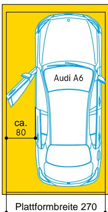
Je nach Fahrzeugmodell und Parkposition des Fahrzeugs auf der Plattform fällt der Platz zur Türöffnung unterschiedlich gross aus. Für komfortable Verhältnisse zum Ein- und Aussteigen empfehlen wir Plattformbreiten ab 270 cm.
