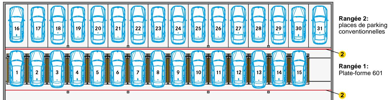
2 Si la longueur du rail est supérieure à 30 m, des barrières lumineuses conformes à la norme DIN EN 14010 doivent être prévues.
