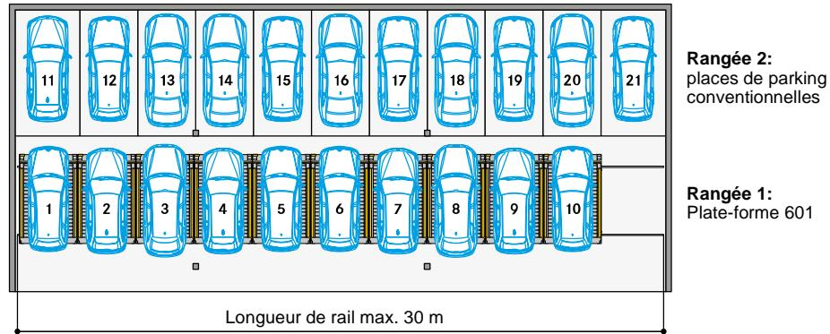
Jusqu'à une longueur de rail de 30 m, aucune barrière lumineuse n'est nécessaire dans la mesure où les distances de sécurité indiquées à la page 3 sont respectées.
