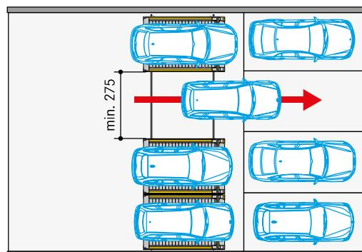
Remarque tirée du règlement allemand relatif aux garages – GaVo §4 (6): Des dérogations aux paragraphes §4, 1 et 2 peuvent être accordées pour les places de stationnement dans des garages sur des plates-formes coulissantes horizontales, à condition qu'il n'y ait aucune objection en matière de sécurité ou d'ordre de la circulation et qu'une largeur de voie d'au moins 2,75 m soit maintenue.
