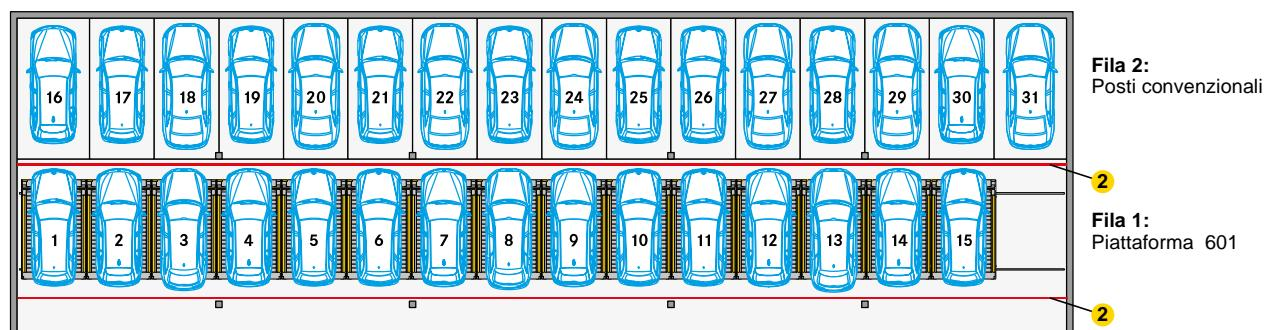
2 Per una lunghezza della guida oltre ai 30 m è necessario prevedere barriere fotoelettriche in conformità alla norma DIN EN 14010.
