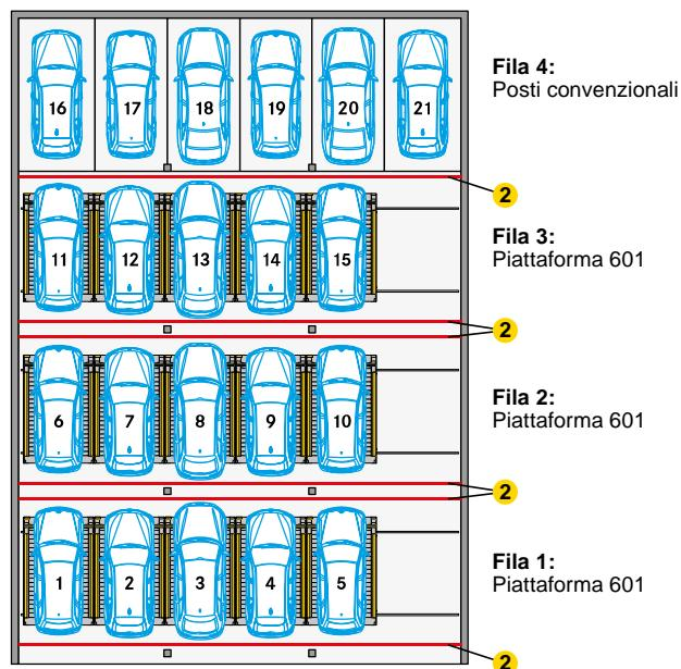
2 Per i sistemi a più file è necessario prevedere barriere fotoelettriche in conformità alla norma DIN EN 14010.
