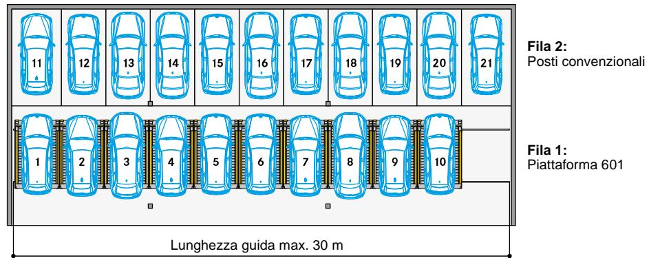
Fino a una lunghezza della guida di 30 m non sono necessarie delle barriere fotoelettriche, purché vengano rispettate le distanze di sicurezza indicate a pagina 3.
