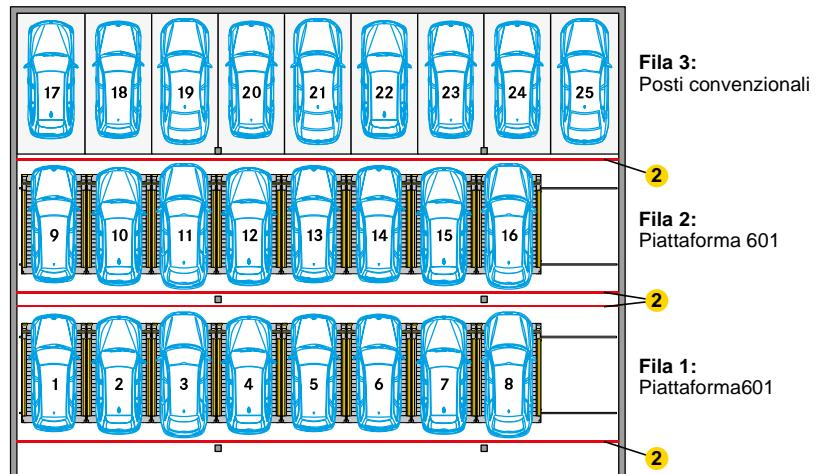
2 Per i sistemi a più file è necessario prevedere barriere fotoelettriche in conformità alla norma DIN EN 14010.
