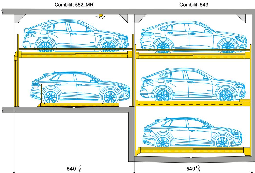
**Exemple de réalisation: Combilift 552-MR/Combilift 542 l'un derrière l'autre (longueur du véhicule 500 cm)**
