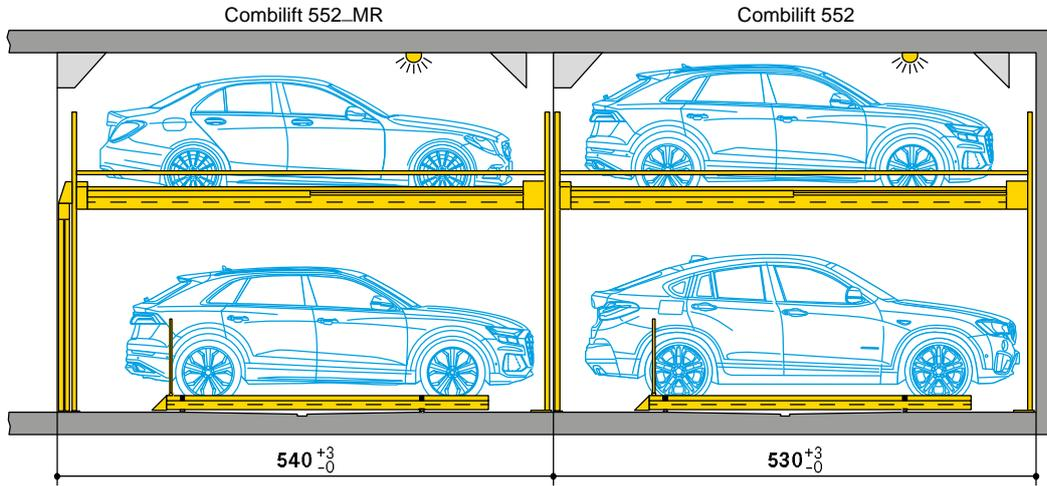
**Exemple de réalisation: Combilift 552-MR/Combilift 543 l'un derrière l'autre (longueur du véhicule 500 cm)**
