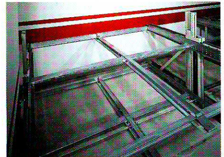
So sieht die Grundkonstruktion für 4 PKW ohne Fahrbleche aus. Die tragenden Seitengewangen sind aus feuerverzinktem Blech nach DIN 17162, NA 275 g/qm, die Traversen sind stückverzinkt nach DIN 50976.
