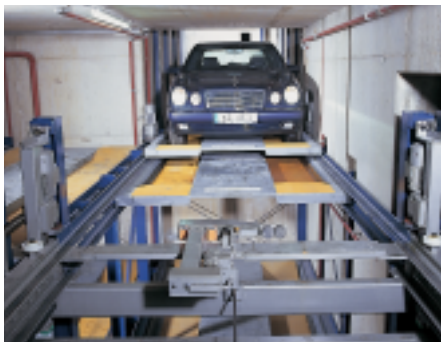
Ist der Einfahrtsraum in das System integriert, übernimmt das Regalbediengerät dort direkt Fahrzeug und Palette. Im Objekt Kronach wurde aus architektonischen Gründen eine entkoppelte Variante geliefert: Ein externer Vertikalförderer bringt Fahrzeug und Palette auf Höhe des Regalbediengeräts, der automatische Palettenschnellwechsel findet in der oberen Lagerebene statt.
