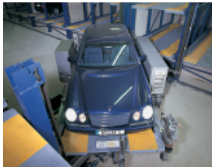
Schon während des Transports zum Einlagern wird das Fahrzeug so gedreht, daß es wieder vorwärts ausfahren kann. Bei den sehr schnellen Horizontalbewegungen ist der Pkw auf dem Regalbediengerät gesichert.
