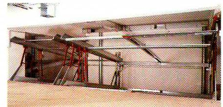
Es erscheint wesentlich, darauf hinzuweisen, daß die Systeme DOGA 313 aus geschraubten Blech-Elementen zusammgebaut werden. Schweißkonstruktionen – und somit geschlossene, schwer mit Farbe zugängliche Bauelemente – werden vermieden. Dort, wo Schweißkonstruktionen unumgänglich sind, werden nur stückverzinkte Oberflächentechniken – etwa bei Torsionsrohren und Haupttraversen – eingesetzt.
